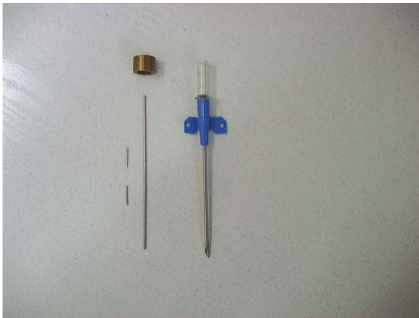
5. ábra Az aktív tű előállításához szükséges alkotóelemek
