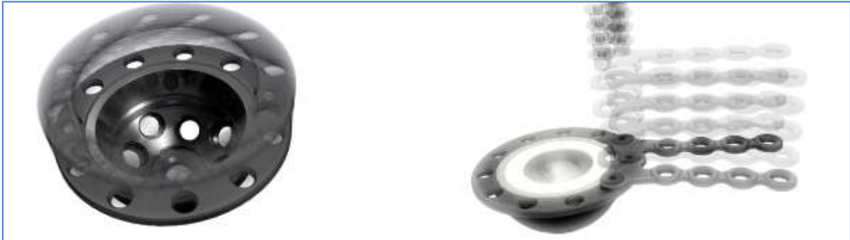
3. ábra - A vápacsésze, gyűrű és "U" lemez kapcsolata – szerzői ábra
