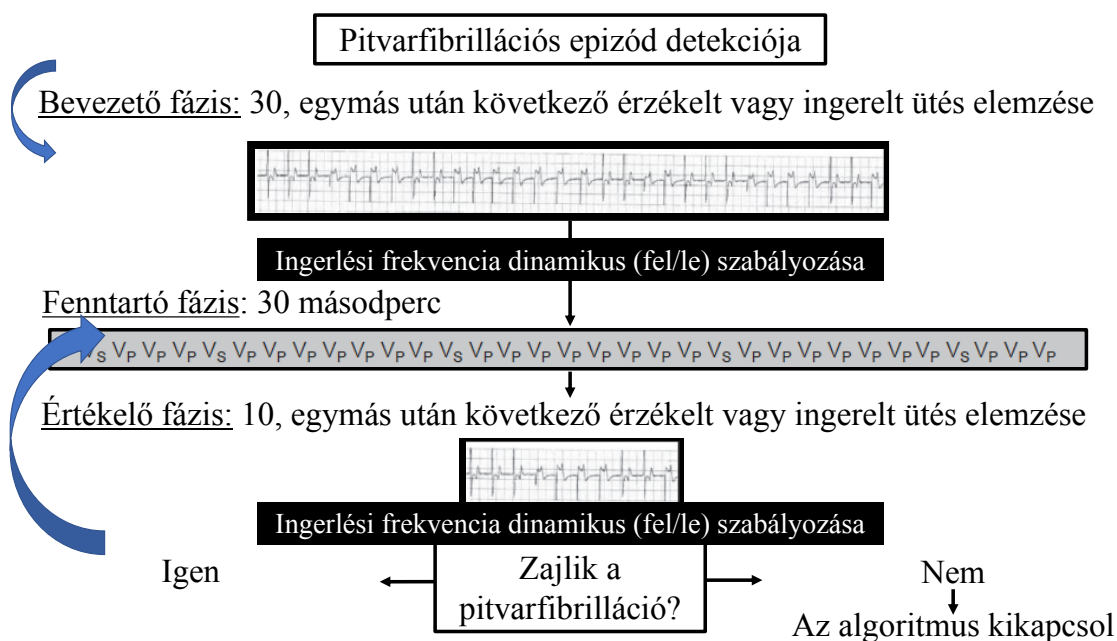
6. ábra. Az effektív CRT-algoritmus (eCRTAF) működésének folyamatábrája zajló pitvarfibrilláció során. V S : érzékelt (senselt) ütés, V P : ingerelt (pacelt) ütés
